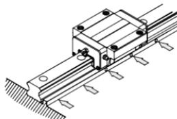
5. 使用扭力扳手，以特定扭力按順序鎖緊裝配螺絲，將滑軌底部基準面逼緊床台底部裝配面。
