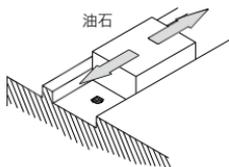
2. 將線性滑軌平穩的放在床台上，並讓滑軌側邊基準面靠上床台裝配面。
