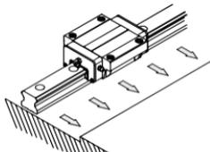
3. 試鎖裝配螺絲以確認螺栓孔是否吻合，並將滑軌底部基準面大概固定於床台底部裝配面。
