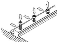
4. 使用側向固定螺釘，按順序將滑軌側邊基準面逼緊床台側邊裝配面，以確定滑軌位置。
